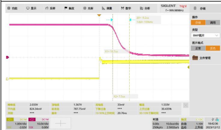
黄色：输入电压；红色：输出电压 下降时间（90%-10%）：9.2µs
