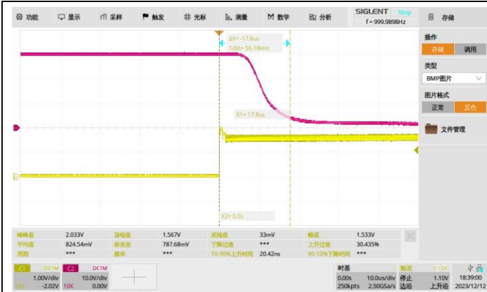
黄色：输入电压；红色：输出电压 导通时间：17.8µs
